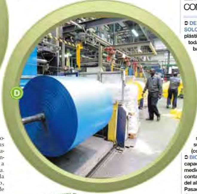
A.- Alfonso Biel, director general de Spheré España. B.- Las bolsas de se fabrican a partir de granzas (bolitas) de polietileno. C.- Mediante un proceso de extrusión se convierten en plástico. D.- Los rollos se cortan según la forma de cada producto y cliente. FOTOS: CHUS MARCHADOR.
